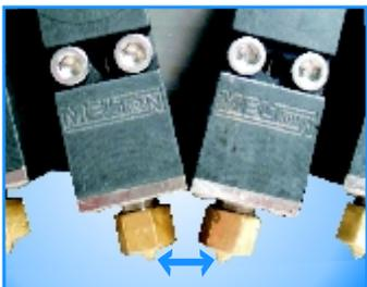
Máxima proximidad de los cabezales para aplicaciones extremas.
